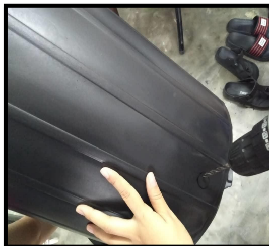
Rajah 3.3 : Proses menebuk lubang kepala paip
